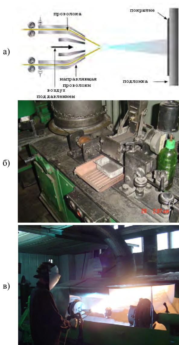
Рис. 1. Электродуговая металлизация порошковой проволоки: а) схема [2]; б) изготовление порошковой проволоки; в) процесс нанесения покрытий
