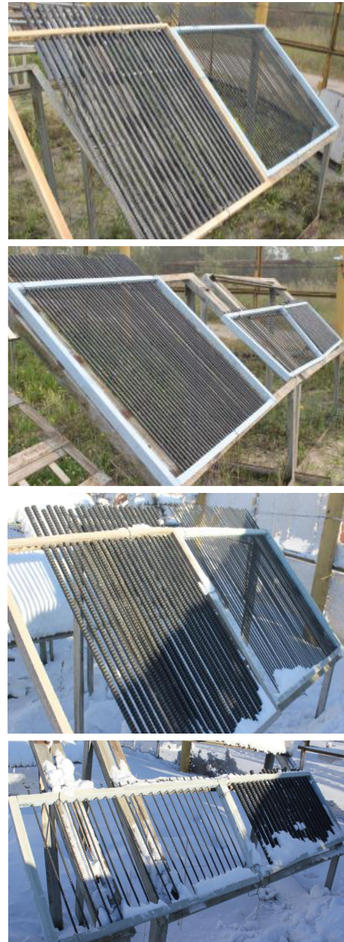
Рис.1. Экспонированные образцы базальтокомпозитной арматуры различных диаметров на открытом полигоне ЦКП ИФТПС
